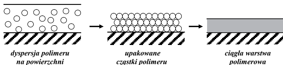
Rys. 2. Powstawanie ciągłej błonki polimeru, wg (3)
